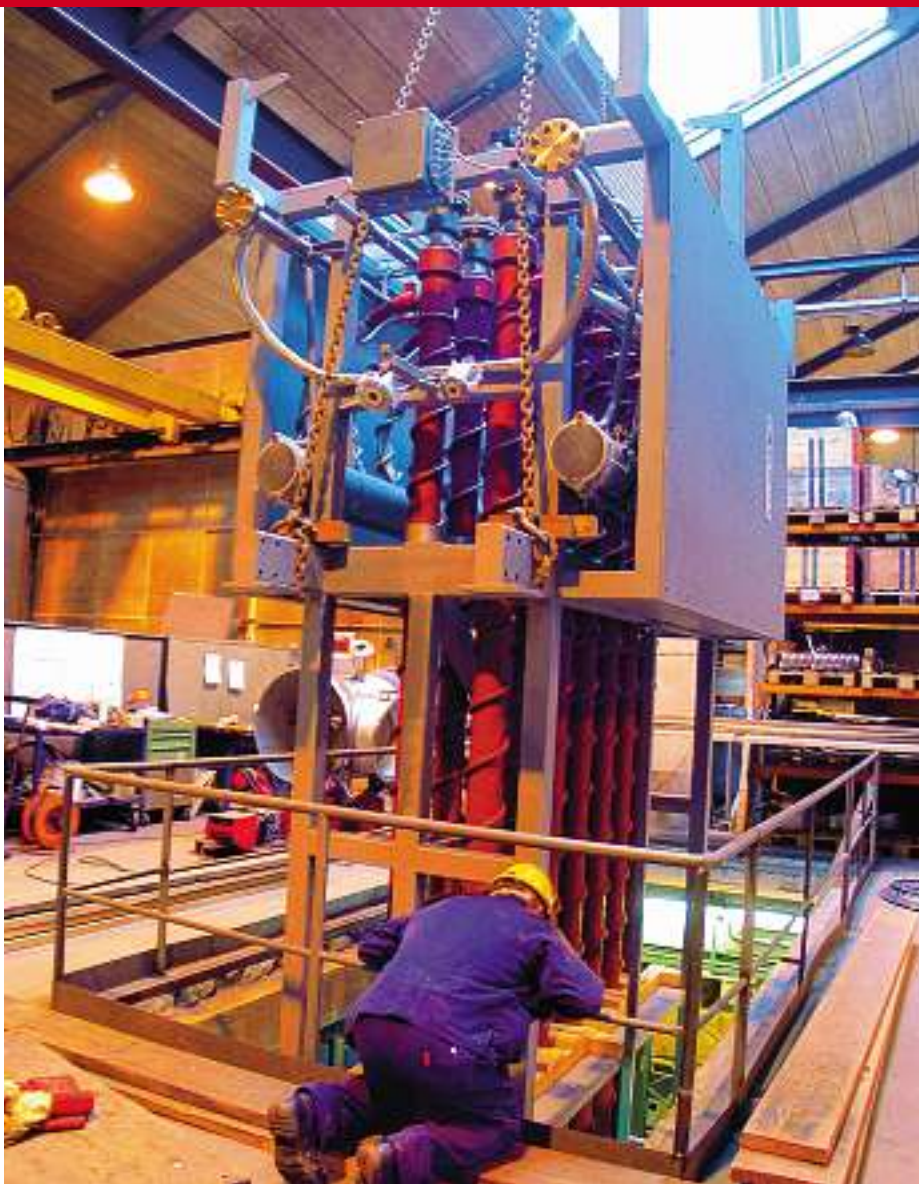
Ein von der Apaco AG im Auftrag der Bertrams Chemieanlagen AG gefertigter Hochkonzentrator für Natronlauge verlässt die Montagehalle übers Dach.
