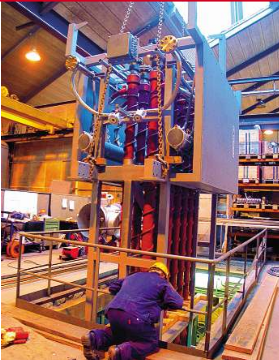
Ein von der Apaco AG im Auftrag der Bertrams Chemieanlagen AG gefertigter Hochkonzentratör für Natronlauge verlässt die Montagehalle übers Dach.
